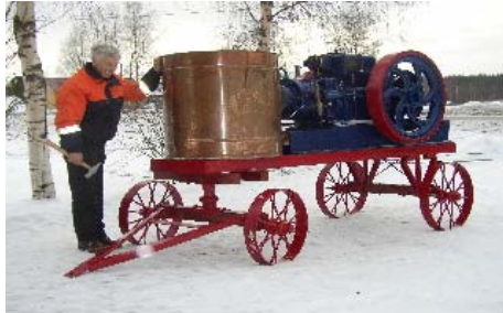
Göran visar stolt upp den renoverade råoljemotorn.
